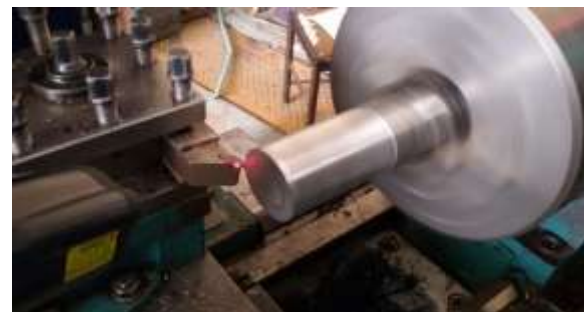
شکل ۱: نمایی از عملیات رو تراشی و ثبت دما
